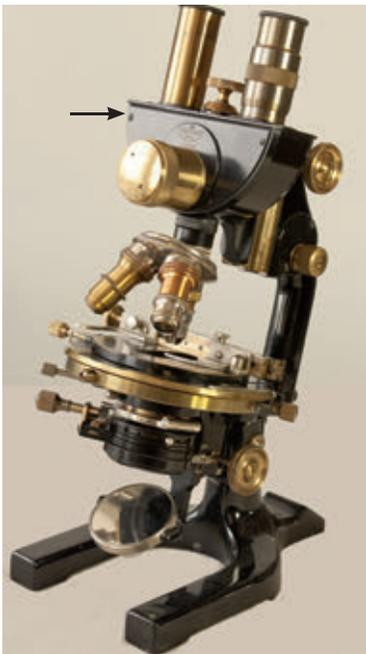
**Рис. 1.4.** Микроскоп фирмы Reichert Austria с бинокулярной насадкой (стрелка)
